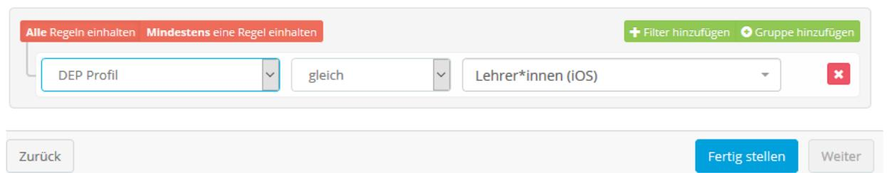
Mit „Fertig stellen“ wird die Regel und die Gerätegruppe gespeichert. Jedes Gerät, dem bei der Registrierung das DEP-Profil „Lehrer\*innen“ zugewiesen wird, kommt in die Gerätegruppe „Lehrer\*innen“ und erhält dort automatisch das Profil „Lehrer\*innen“.
