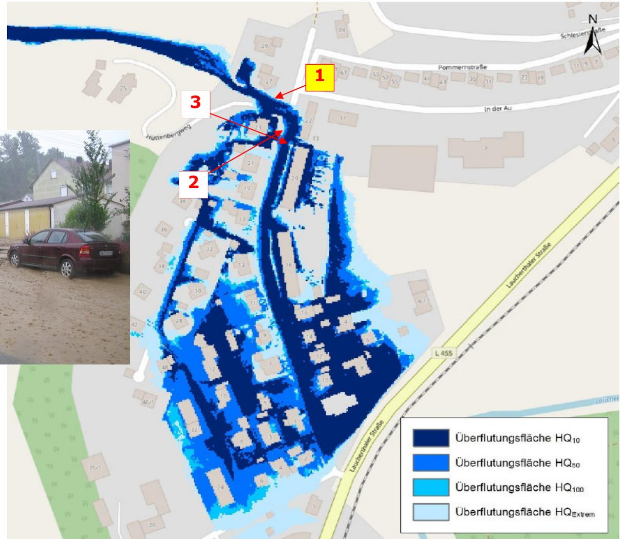
Abbildung 3: Überflutungsproblematik, links: Berechnete Überflutungsflächen für verschiedene Jährlichkeiten von Winkler&Partner 2020 ergänzt mit Fotonummer; Ober/Mitte/Unten Hochwasserereignis 2008, Aufnahmezeitpunkt siehe Nummerierung, Aufnahme Gemeinde Sigmaringendorf 2009.
