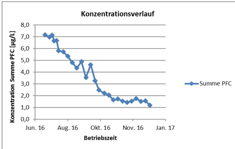
Abbildung 4: Entwicklung der Schadstoffkonzentration im Anlagenzulauf während der Phase 2 (hier dargestellt für Summe PFC)
