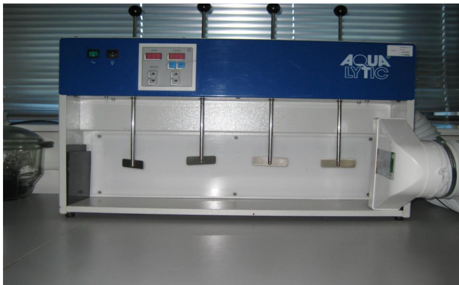
Abb. 14: Reihenrührwerk für Technikumsversuche (sog. Batch-Versuche / Jar-Tests)
