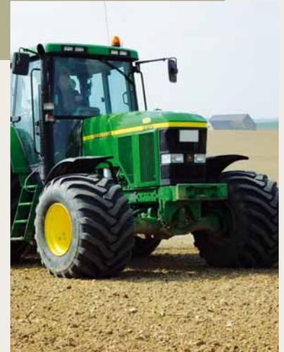
Last auf eine möglichst große Fläche durch Breit- oder Terrareifen oder die Anpassung des Reifeninnendrucks beitragen. Auch die Vorhaltung von Schlagkraft hilft Bodenverdichtungen vorzubeugen, da bei feuchten Bedingungen auf Befahren und Bearbeiten verzichtet werden kann. Denn im trockenen Zustand verfügen Böden über deutlich mehr Tragfähigkeit und lassen sich nicht so leicht verformen.
